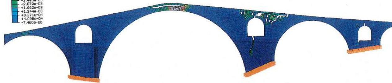
Σχήμα 9.8. Μορφή αστοχίας – πλαστικές παραμορφώσεις του ενισχυμένου μακρομοντέλου για την εντός επιπέδου φόρτιση -X, νότια όψη.
