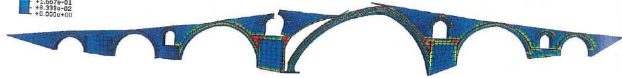
Σχήμα 7.15. Αστοχία διεπιφανειών και παραμορφωμένη κατάσταση μετά την πτώση της φέρουσας ικανότητας, για την φόρτιση +X.
