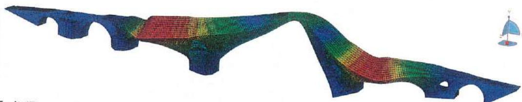
Σχήμα 7.7: 4 η Ιδιομορφή, μεταφορική κατά Z (εκτός επιπέδου) με ιδιοπερίοδο 0.187s και ποσοστό ενεργοποίησης μάζας 21%
