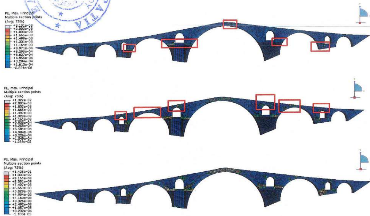
Σχήμα 9.11. Εμφάνιση και εξέλιξη πλαστικών παραμορφώσεων ενισχυμένου μοντέλου γέφυρας υπό τον σεισμό της Κοζάνης. Από πάνω προς τα κάτω, οι πλαστικές παραμορφώσεις την χρονική στιγμή t=6.25s , t=6.90 και στο τέλος της ανάλυσης
