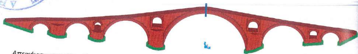
Απεικόνιση της νότια όψης του φορέα της γέφυρας στην οποία διακρίνεται η υπό έλεγχο κρίσιμη διατομή.
