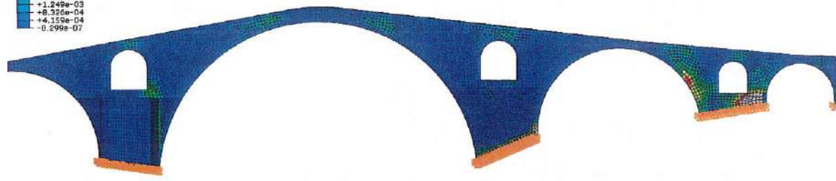
Σχήμα 9.4. Μορφή αστοχίας – πλαστικές παραμορφώσεις του ενισχυμένου μακρομοντέλου για την εκτός επιπέδου φόρτιση +Z, νότια όψη.
