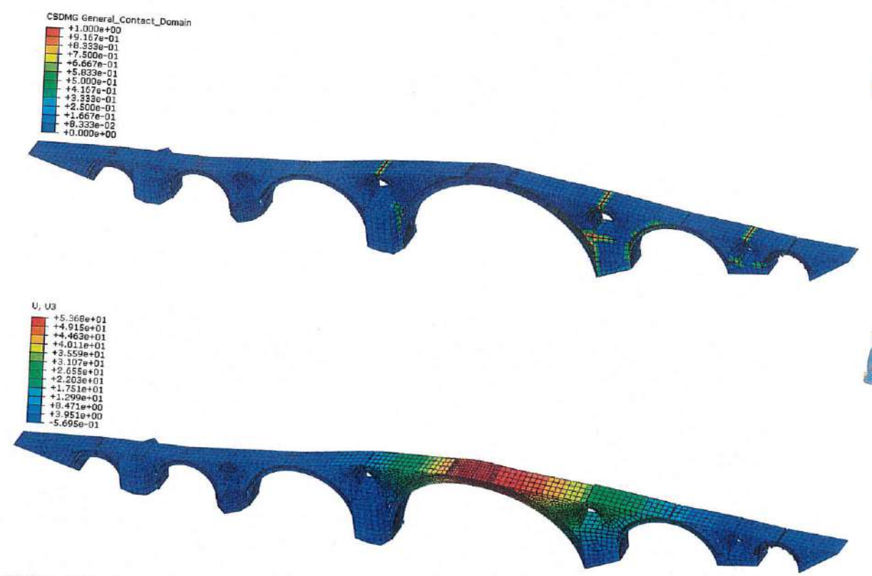
Σχήμα 7.12. Αστοχία διεπιφανειών (πάνω) και παραμορφωμένη κατάσταση – εκτός επιπέδου μετακινήσεις (κάτω) μετά την πτώση της φέρουσας ικανότητας, για την φόρτιση +Z.
